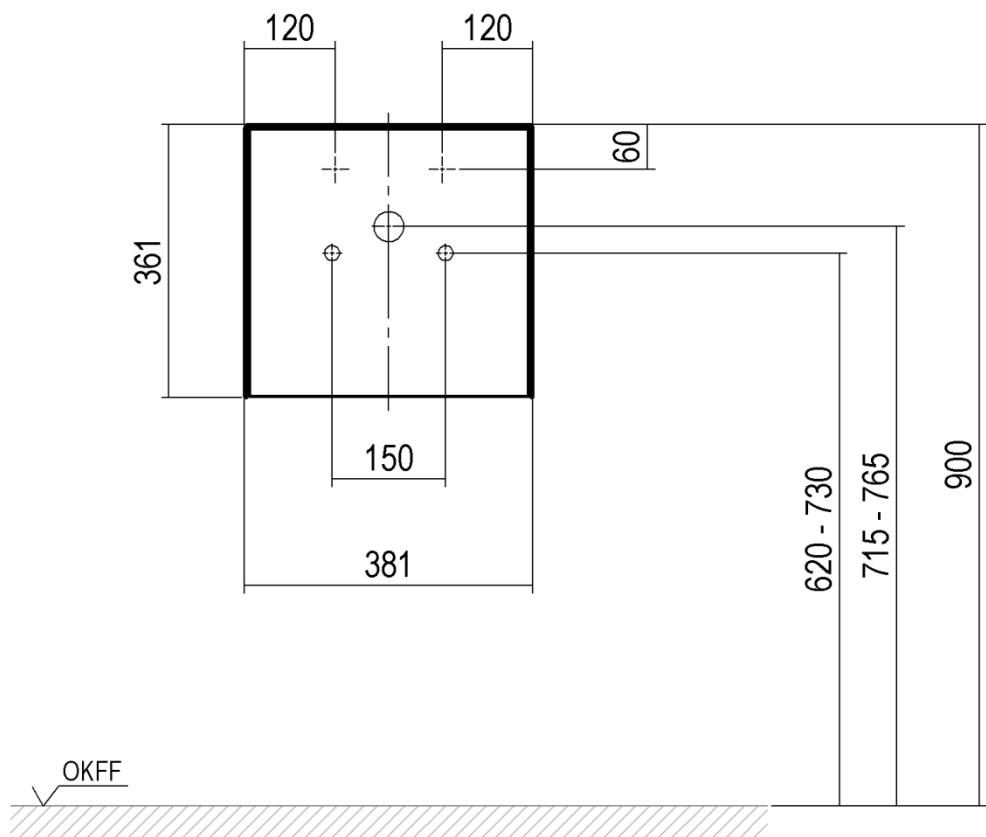
\*OKFF = Oberkante Fertigfußboden / Finished Floor Level (FFL)
